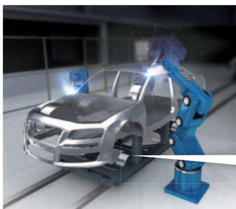
待焊接金属板的到位确认
